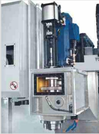
Testa con trasmissione a ingranaggi
