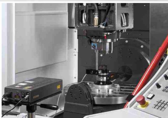
Controllo laser eseguito sulla tavola roto-basculante
