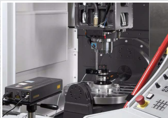
Controllo laser eseguito sulla tavola roto-basculante
