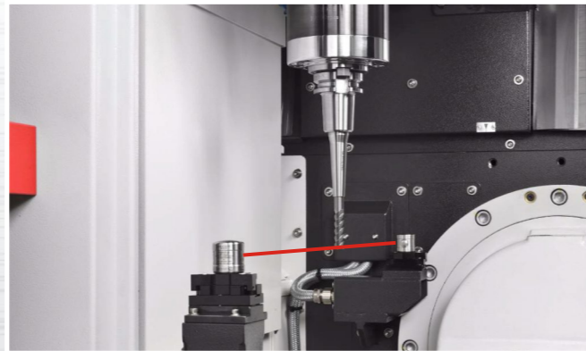
Presetting Renishaw per controllo dimensionale e ispezione
