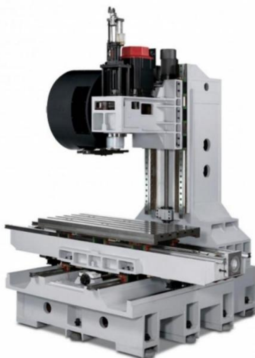
Struttura macchina su guide a rulli
