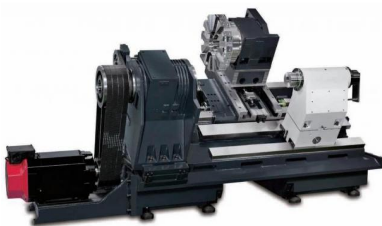
Struttura macchina su guide piane
