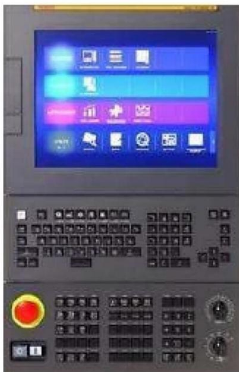
Nuovo CNC Fanuc Oi-TF PLUS con schermo LCD 15"
