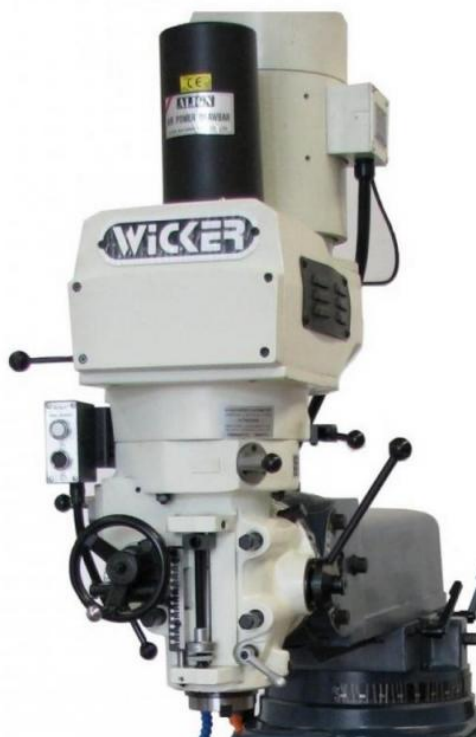
Testa con inverter inclinabile in 4 posizioni (DX/SX/fronte/retro)
