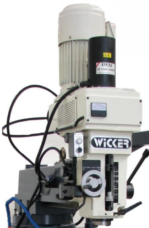
Testa con inverter inclinabile in 2 posizioni (DX/SX)
