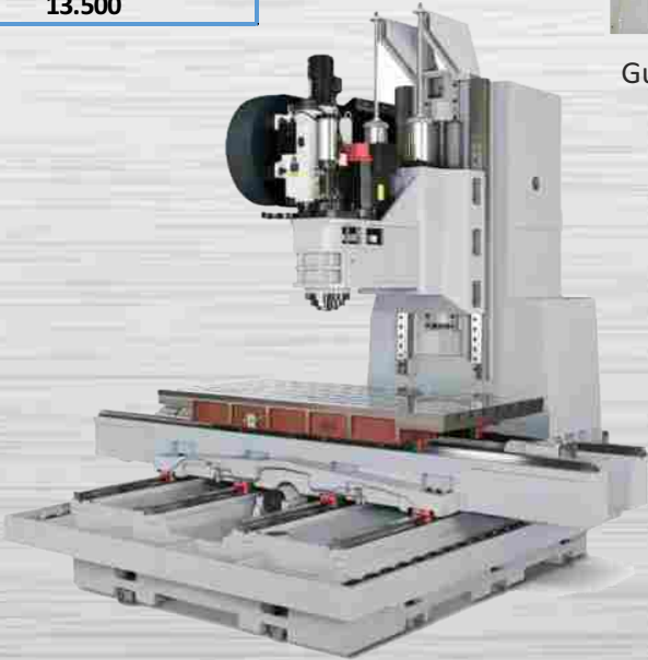
Struttura PM/DM 1600/1800/2000 con 4 guide lineari PM/DM 2076 con 4 guide lineari + 2 di supporto
