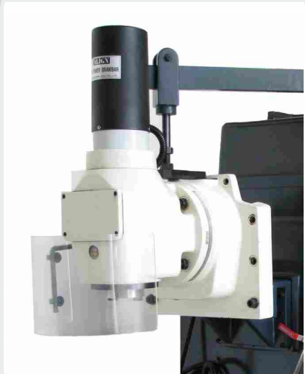
Testa universale a 9 velocità con braccetto di supporto per montaggio rapido
