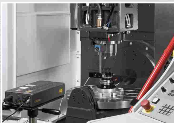
Controllo laser eseguito sulla tavola roto-basculante
