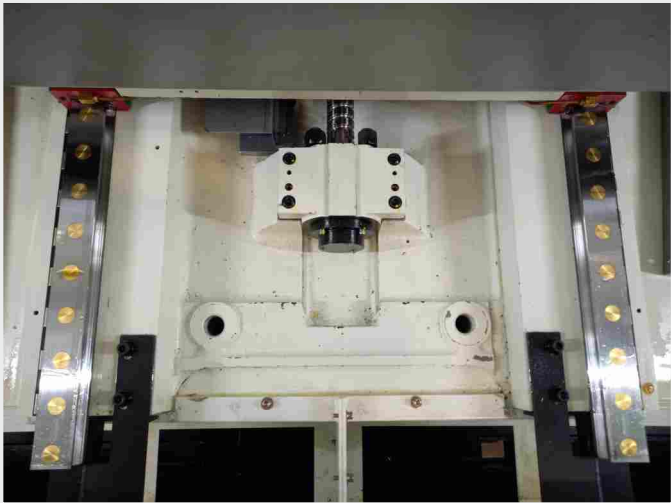
Guide lineari con tappi in ottone (anziché in plastica) per evitare deformazione e accumulo polvere metallica
