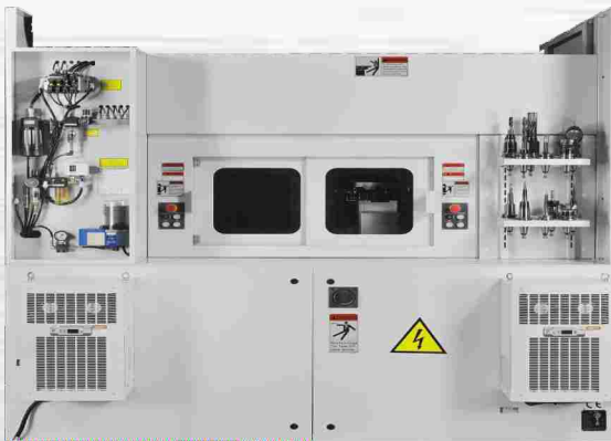
Accesso magazzino utensili e impianti posteriore
