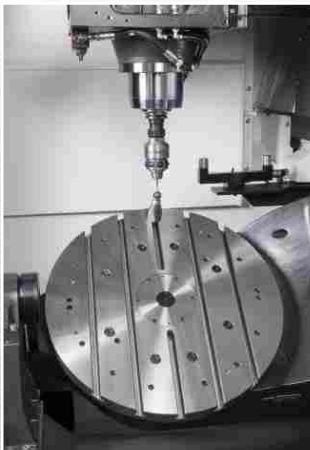
Software Kinematics e sfera per la calibrazione degli assi
