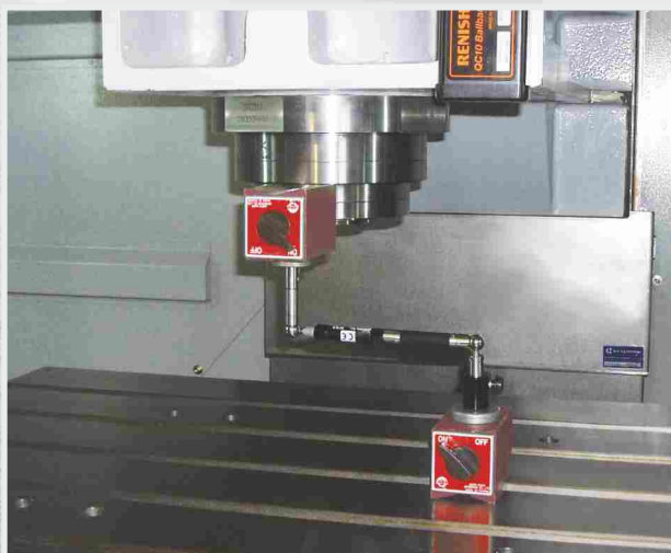
Controllo geometria tramite Ballbar Renishaw effettuato su ogni macchina
