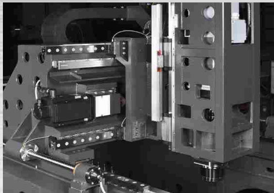
Struttura su guide lineari con motori diretti X/Y/Z
