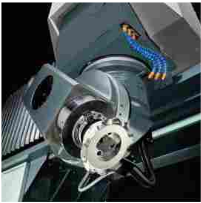
Testa a 2 assi - asse B/C 26 Kw - 3000 rpm (grasso) - 1°/5° 26 Kw - 4000 rpm (aria/olio) - 1°/1°
