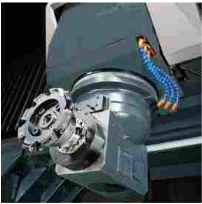
Testa fissa a 90 gradi - asse C 26 Kw - 3000 rpm Indexaggio asse C 1°/5°
