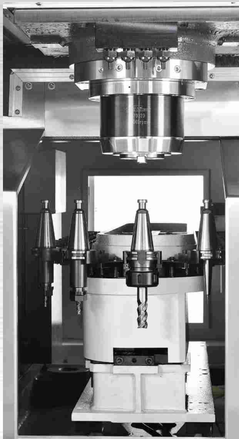
Cambio utensili a cestello posteriore
