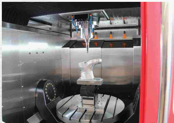
Tavola roto-basculante con motori diretti
