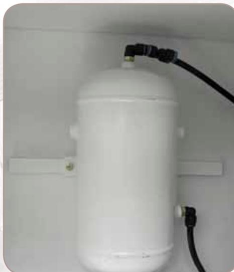
Impianto pneumatico con serbatoio indipendente per il sistema cambio utensile per garantire massima efficienza e affidabilità al sistema stesso.
